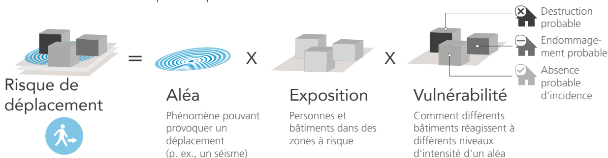
FIGURE 18 : Comment le risque de déplacement est-il calculé ?
